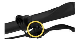
1. Utilisez la clé hexagonale n° 5 pour desserrer le boulon du levier de frein droit dans le sens inverse des aiguilles d'une montre.
