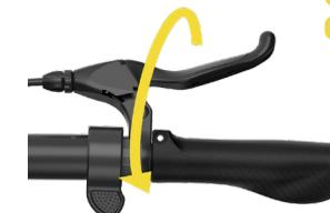
2. Une fois que le boulon est suffisamment desserré, réglez le levier de frein sur une position appropriée et confortable. Utilisez la clé hexagonale n° 5 pour serrer le boulon dans le sens des aiguilles d'une montre.
