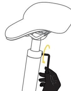
1. Utilisez la clé hexagonale n°5 pour desserrer le boulon de serrage en tournant dans le sens inverse des aiguilles d'une montre jusqu'à ce que vous puissiez faire bouger la selle facilement sans la forcer.
