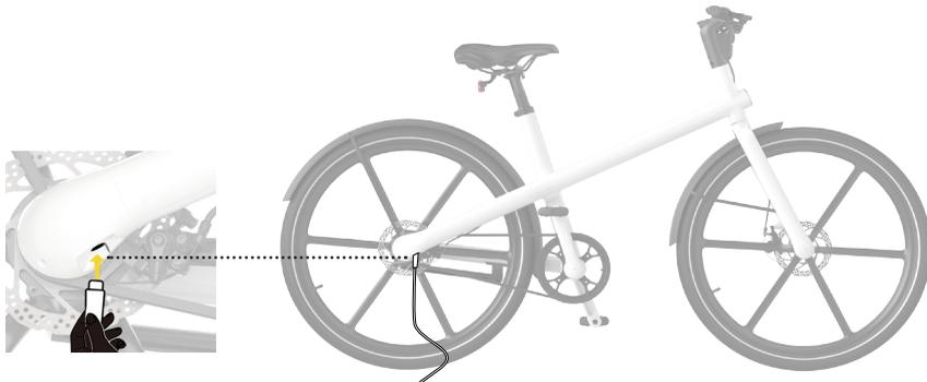
Ouvrez doucement le capot en caoutchouc, connectez la prise du chargeur au port de charge. La recharge peut être terminée pendant environ quatre heures, une fois que le voyant LED rouge devient vert, cela indique que l'énergie est pleine. En cas d'énergie faible, la dernière cellule de la bande d'affichage de l'énergie clignote, l'appareil doit être chargé immédiatement.
