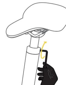
3. Serrez les vis dans le sens des aiguilles d'une montre à l'aide d'une clé Allen Hex Key #5.
