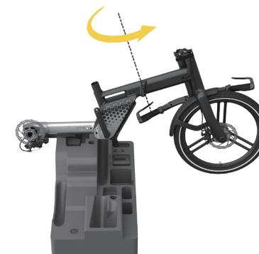
6. Sortez le vélo du carton, dépliez le cadre du vélo dans le sens des aiguilles d'une montre et placez-le sur la mousse.
