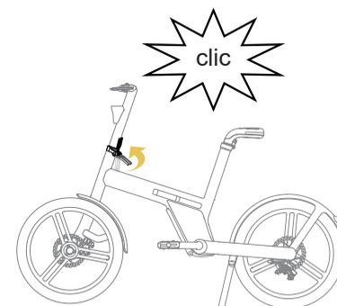
6. Soulevez la mâchoire de charnière et appuyez fermement dessus jusqu'à entendre un "clic", indiquant que la mâchoire de charnière est bien verrouillée en place.
