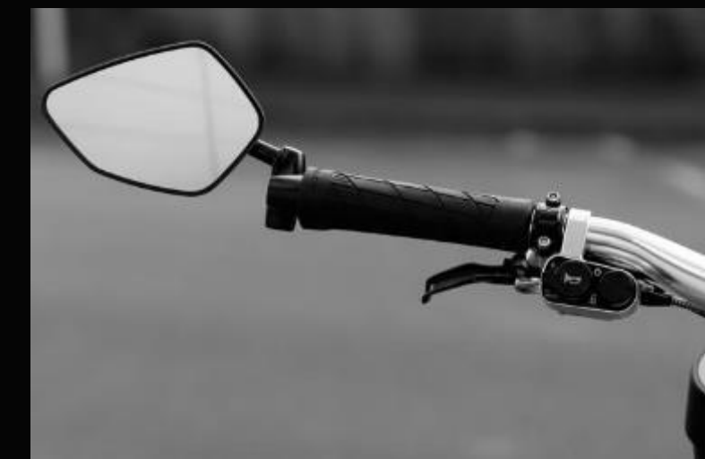
RETROVISEUR ET AVERTISSEUR SONORE Rear mirror and horn integrated
